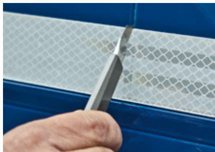
08 Folie an Panel-Übergängen, Türen oder Klappen mit einem Cutter trennen
