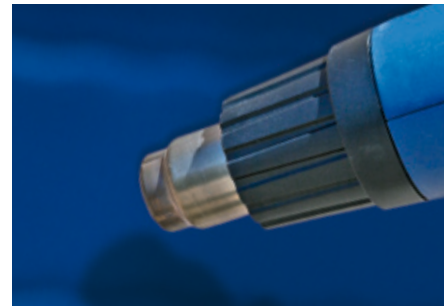
03 Untergrund, falls erforderlich, erwärmen
